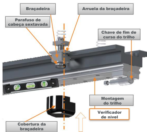
Figura 22 (ZGCM-48 e ZGCM-66 com porcas com molas)
