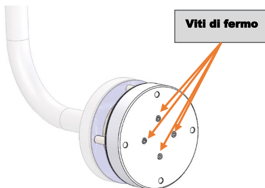
Figura 29: Punto di collegamento dello schermo ZGCMRS
